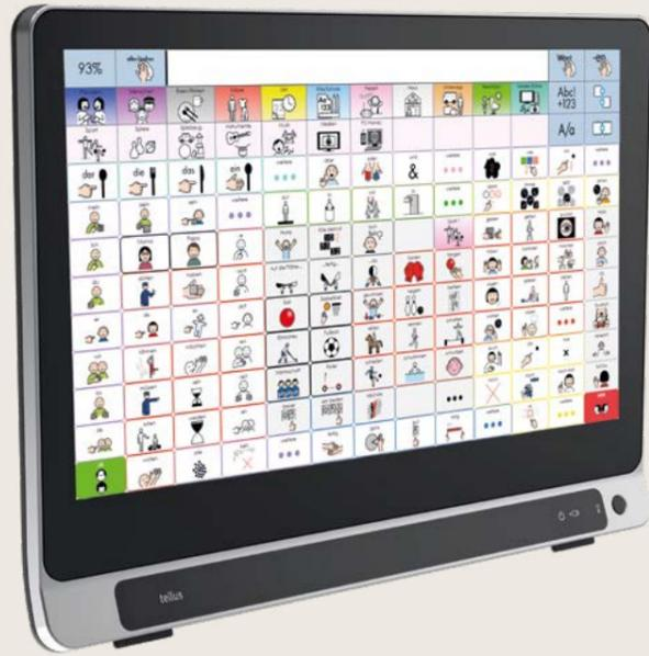
MyCORE Eyecontrol ist eine leistungsstarke Kommunikationshilfe mit integrierter Augensteuerung und das Ergebnis das Ergebnis langjähriger Erfahrung im Bereich der Unterstützten Kommunikation. Die Augensteuerungstechnologie kommt aus dem Hause Tobii und beinhaltet die neueste Eyetracker Generation. Neben der Bedienung über Blicksteuerung stehen auch Touchscreen, Maus- oder Mauseinsatzgeräte sowie Taster als Eingabemethode zur Verfügung.
