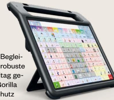
Auch in technischer Hinsicht erfüllt das MyCORE 10 die alltäglichen Ansprüche einer Kommunikationshilfe: 10,5" Full HD kapazitiver Touchscreen (mit wake-up Funktion), leistungsstarke Lautsprecher, ein eingebauter Aufstellfuß, Front- und Rückkamera, eine lange Batterielaufzeit sowie Wifi und Bluetooth.
