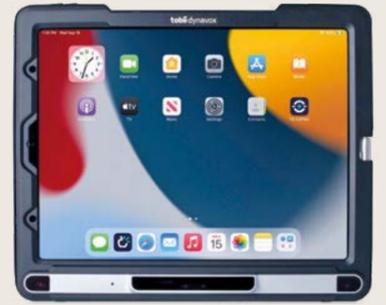
TD Pilot ist eine Kommunikationshilfe mit Augensteuerung für das iPad. Das auf iPadOS basierende Hilfsmittel wurde entwickelt, um Menschen mit Erkrankungen wie ALS, Rückenmarksverletzung oder Zerebralparese die Kommunikation und Nutzung ihres Tablets über Blicksteuerung zu ermöglichen. Es kann über Augensteuerung bei allen Lichtverhältnissen genutzt werden, auch im Freien.
