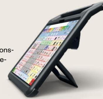
Auf der technischen Seite punktet das MyCORE mit einem leistungsstarken Intel i5-Prozessor. Dank des großen 12"-Bildschirms mit einer hohen Auflösung (2736 x 1824 Pixel) sind einzelne Felder besser sichtbar und bieten ein größeres Ziel bei der Ansteuerung im Vergleich zum MyCORE 10. Leistungsstarke Lautsprecher, ein eingebauter Aufstellfuß, Front- und Rückkamera, eine lange Batterielaufzeit, optionale Umfeldkontrolle sowie Wifi und Bluetooth sind weitere technische Merkmale.
